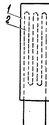
Рис. 94. Проволоочный датчик: 1 — бумажное покрытие; 2 — константовая проволока.
