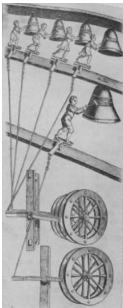
Рис. 108. Автомат для боя часов и четвертей часов из Льежа
