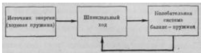
Рис. 221. Блок-схема автоматического регулирования хода часов
