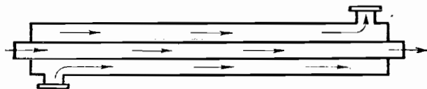
Фиг. 54. Теплообменный аппарат („труба в трубе“) с параллельным током.
