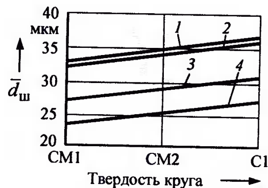
Рис. 1.32. Влияние твердости шлифовального круга на средний размер частиц механических примесей \bar{d}_{ш} [11]: заготовки из стали ШХ 15, HRC 61...64; круг 1 — 600×40×305; 1, 4 — v_s = 0,8 мм/мин; \tau = 180 с; 2, 3 — v_s = 0,15 мм/мин; \tau = 10 с; 1, 2 — зернистость круга 40; 3, 4 — зернистость 12
