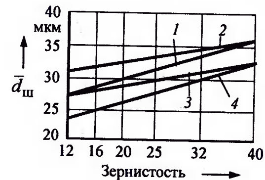
Рис. 1.31. Влияние зернистости шлифовального круга на средний размер частиц механических примесей \bar{d}_{ш} [11]: заготовки из стали ШХ15, HRC 61...64; круг 1 — 600×40×305; 1, 3 — v_s = 0,15 мм/мин; \tau = 10 с; 2, 4 — v_s = 0,8 мм/мин; \tau = 180 с; 1, 2 — твердость круга C1; 3, 4 — твердость CM1
