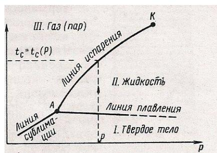
Рис. 10. Диаграмма фазовых состояний чистого вещества (однокомпонентная система).
