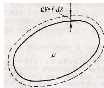
Рис. 6. Работа расширения тела (общий случай изменения объема).
