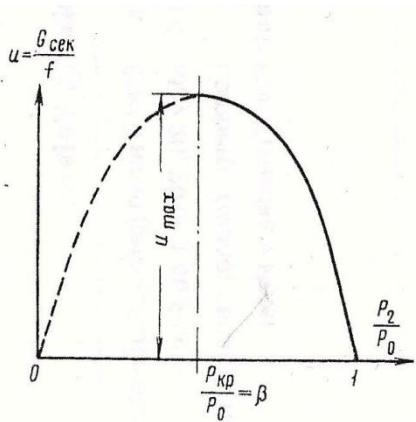
Рис. 27. Зависимость теоретической весовой (массовой) скорости истечения сжимаемых жидкостей от соотношения давлений потока до и после расширения.
