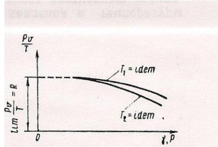
Рис.12. Опытное определение характеристической постоянной идеального газа ( $R$ ).
