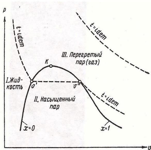
Рис. 24. Состояния жидкости, насыщенного пара и перегретого пара или газа в координатах  $P - \vartheta$ .
