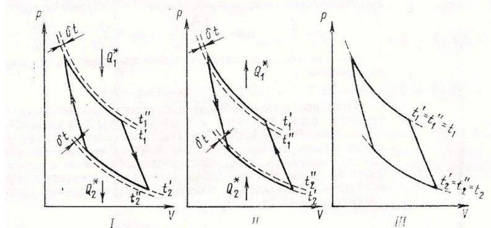
Рис. 17. Круговые процессы (цикли) тепловых машин.
