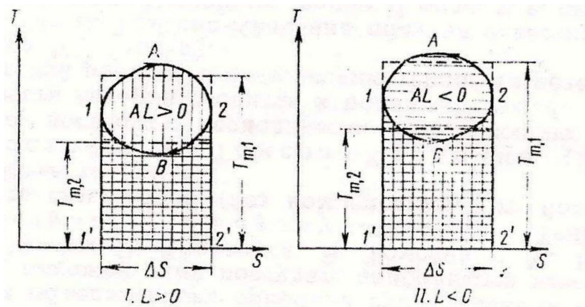
Рис. 21. Термодинамические циклы тепловых машин (координаты  $T - S$ )
