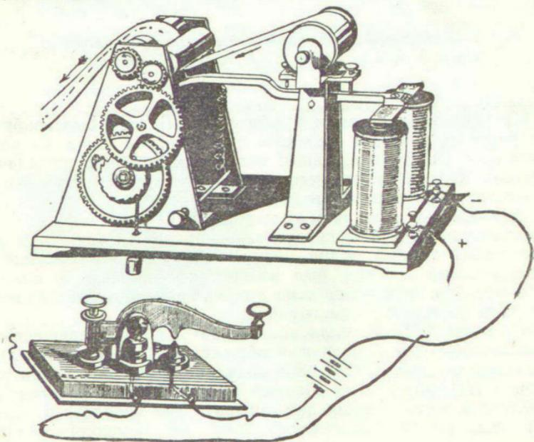
*Рис. 1. Старинный рисунок телеграфного аппарата Морзе.*
