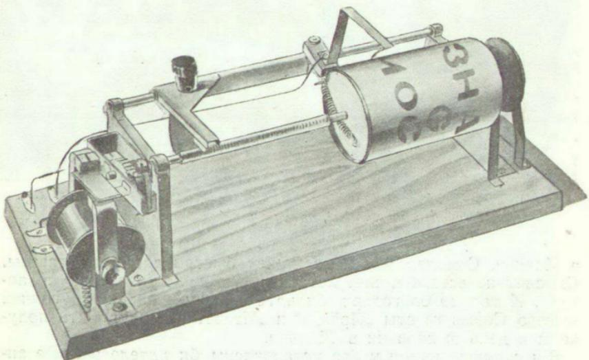
Рис. 12. Самодельный передающий аппарат. Слева видно устройство шагового реле. К барабану с изображением прикасается снимающий контакт. Справа виден диск тормоза.
