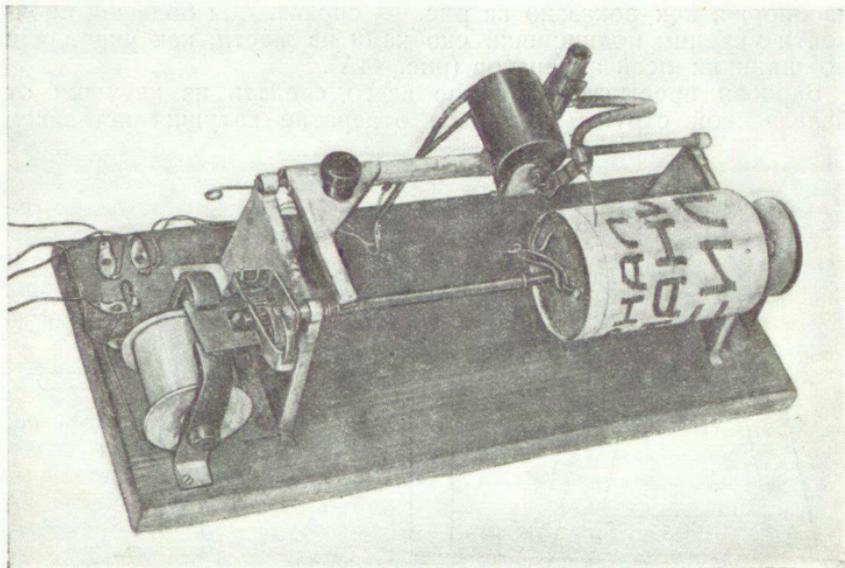
*Фото самодельного приемного бильдаппарата.*
