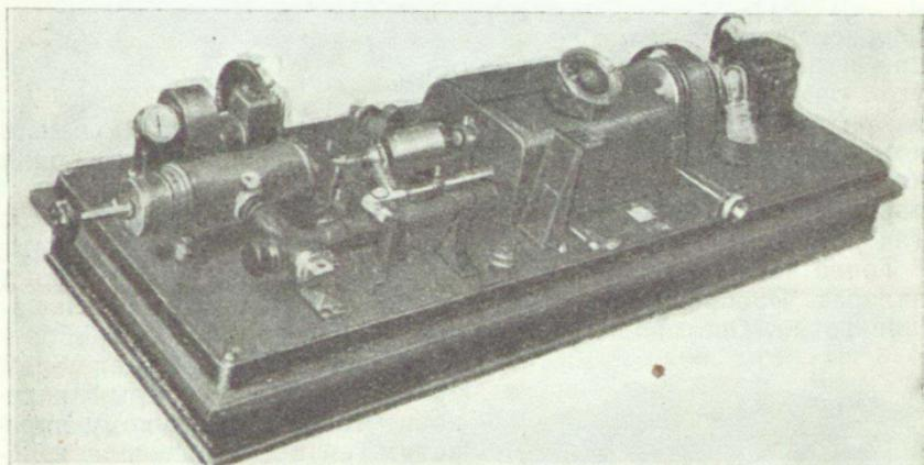
Рис. 6. Немецкий бильдаппарат фирмы „Телефункен“.
