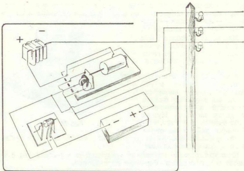
Как происходит передача изображений? Приготовленное изображение накладывается на барабан передающего аппарата и закрепляется застёжкой. Каретка с контактом ставится в исходное положение. Всегда перед началом передачи застёжка должна ставиться против контакта. Прерыватель поворачивается в положение разомкнутых контактов.
