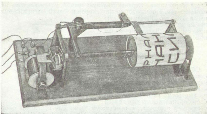
*Фото самодельного передающего бильдаппарата.*
