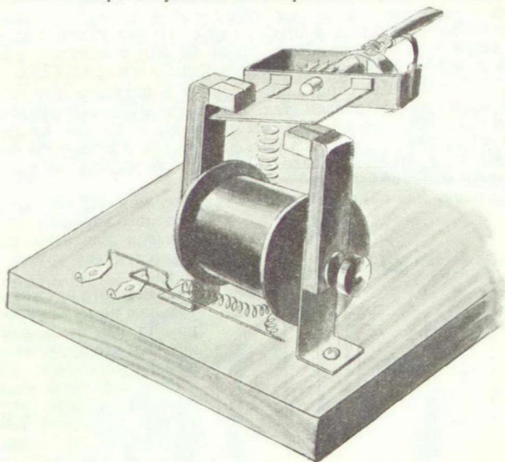
Рис. 28. Общий вид готового шагового реле.
