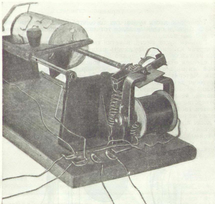
*Фото собранного шагового реле на аппарате.*
