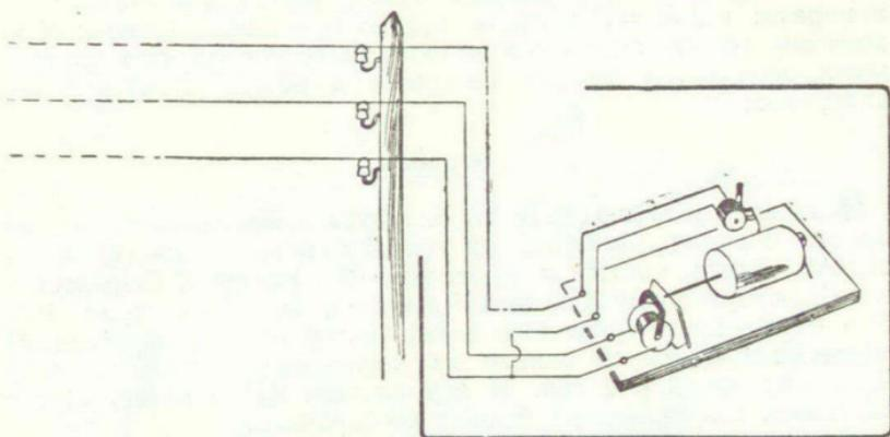
Рис. 15. Схема бильдаустановки. Слева передающий аппарат с прерывателем и батареей. Справа приемный аппарат. Три провода связывают аппараты между собой.
