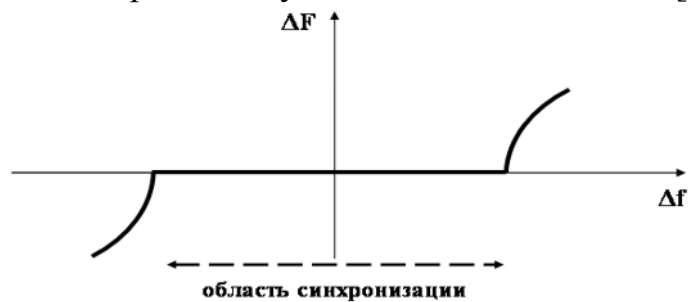
Рис. 2. График «разность наблюдаемых частот – расстройка» для некоторой фиксированной силы связи
