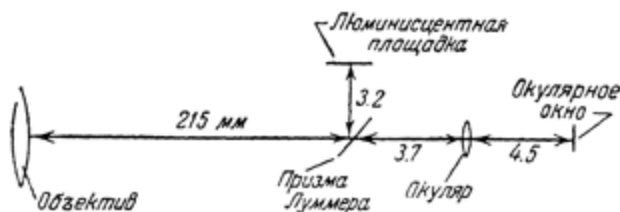
Рис. 13. Схема радиоактивного фотометра.
