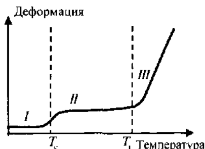
Рис. 6.9. Термомеханическая кривая аморфного линейного полимера.
