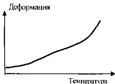
Рис. 6.11. Термомеханическая кривая полимолекулярных полимеров.
