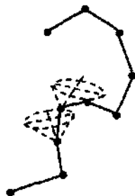
Рис. 2.7. Конформация цепи с фиксированными валентными углами.
