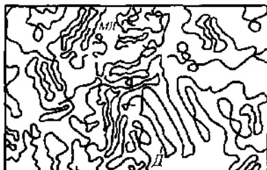
Рис. 3.17. Модель строения аморфного полимера по Йею: Д – упорядоченный домен, МД – междоменная область.
