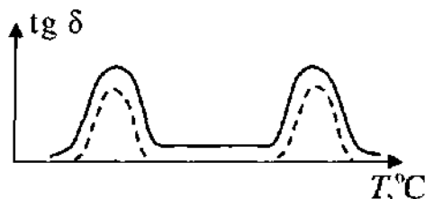
Рис. 17.2. Зависимость механических потерь от температуры для смесей несовместимых полимеров (пунктир – для отдельно взятых исходных полимеров).
