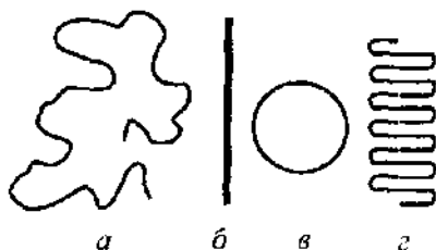
Рис. 2.8. Конформации макромолекул: а — макромолекулярный клубок; б — вытянутая жесткая палочка; в — глобула; г — складчатая конформация.
