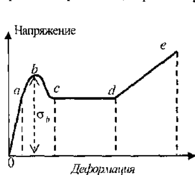
Рис. 7.2. Зависимость деформации от напряжения для стеклообразных полимеров (деформация с образованием "шейки").
