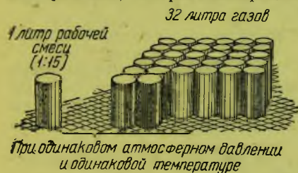
Рис. 2. После сгорания одного литра рабочей смеси получается 32 литра газов
