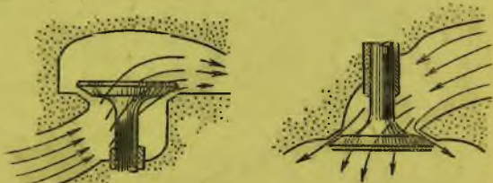
Потоки газов при верхних и нижних клапанах
