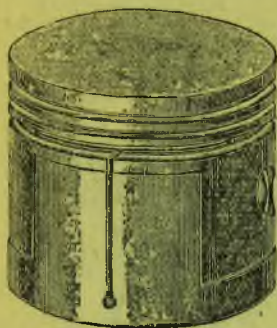
Рис. 29. Поршень мотоцикла ПМЗ-А-750.
