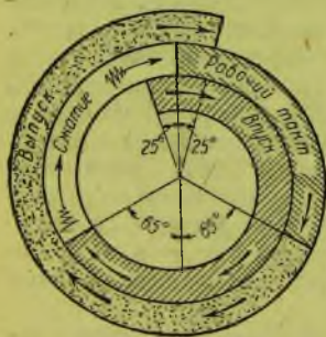
Рис. 18. Диаграмма газораспределения двигателя ТИЗ-АМ-600
