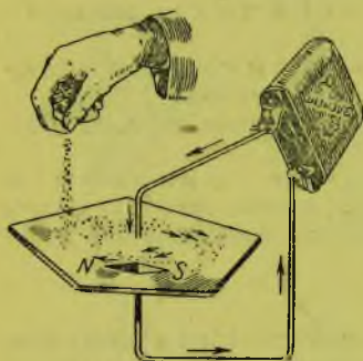
Рис. 106. Железные опилки располагаются вокруг провода концентрическими кругами
