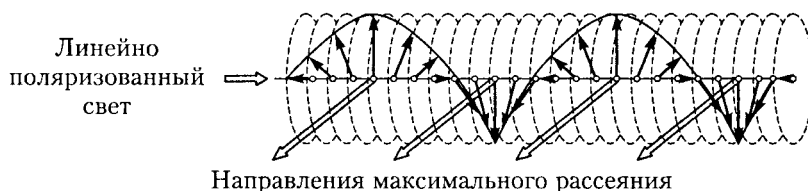
Рис. 15.5. Рассеяние света в мутной оптически активной среде (винт Фарадея)
