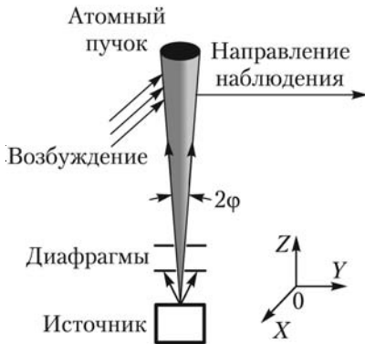
Рис. 13.10. Метод атомного пучка
