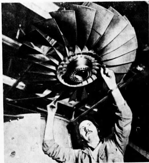
Модель вентилятора с рабочими лопатками малого удлинения.
