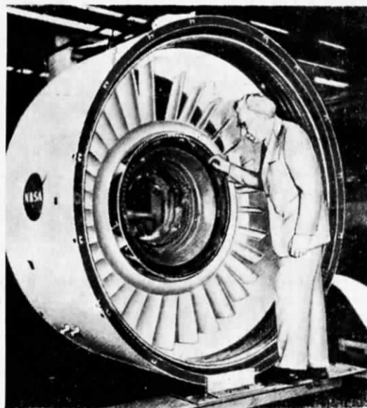
Графито-эпоксидный силовой корпус вентилятора двигателя QCSEE.
