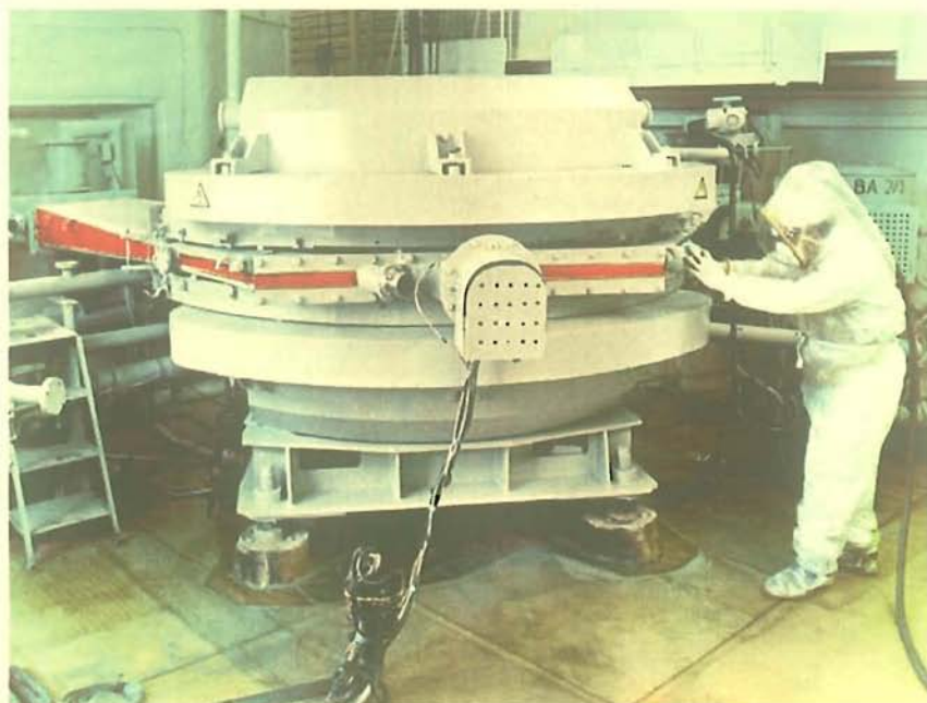
Уникальный электромагнитный масс-сепаратор С-2 для получения высокообогащенных радиоактивных изотопов (ВНИИЭФ)
