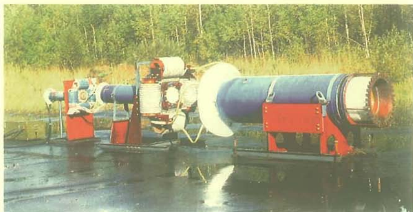
Каскад взрывомагнитных генераторов (ВНИИЭФ)
