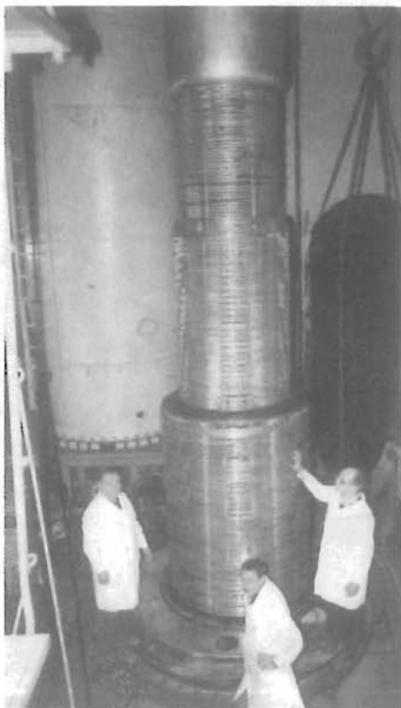
Электростатический генератор ЭГ-8
