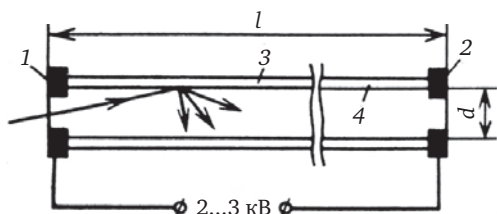
Рис. 2.47. Схема канала канального усилителя: 1, 2 — электроды; 3 — диэлектрик; 4 — эмитирующий слой
