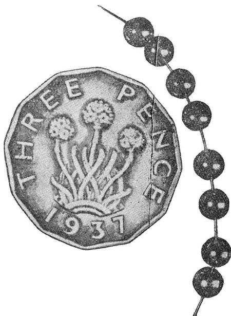
Фиг. 92. Прошивка отверстий малого диаметра в стальных шариках (монета помещена для сравнения).
