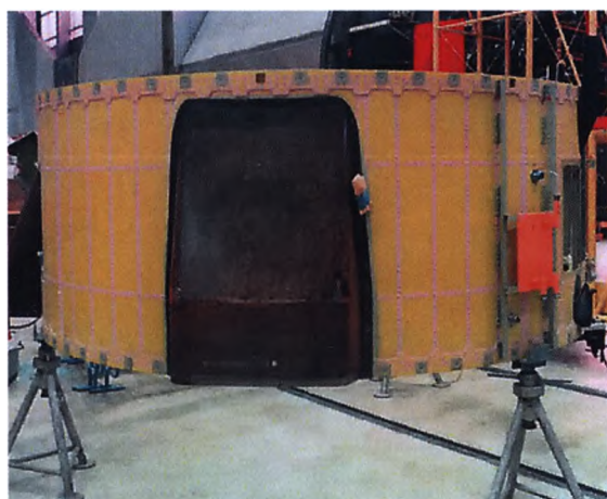
Сборка Д1 (отработка ПГС ДУ, СПП, СТ и ПБ): межбаковый отсек
