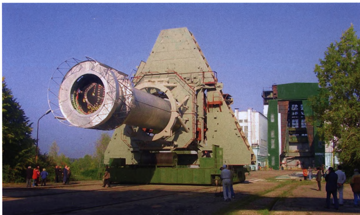
Транспортировка УРМ-1 без двигателя на стенд
