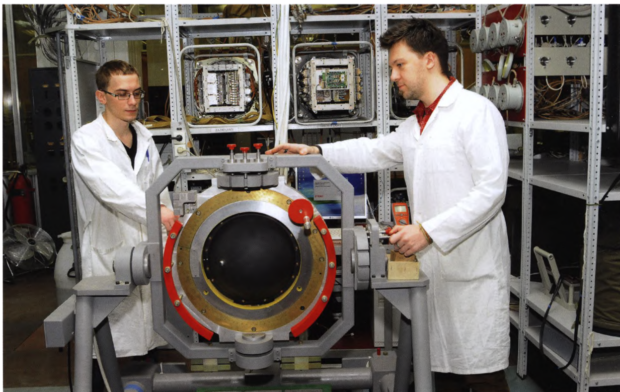
Нач. группы А.Ю. Домарев объясняет инж.2к. П.А. Малинину способы ориентации ККП (ГСП) с помощью поворотного стола
