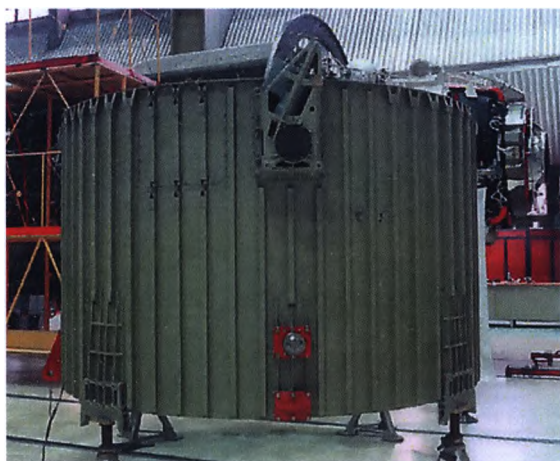
Сборка В2 (отработка динамической прочности): хвостовой отсек с монтажами
