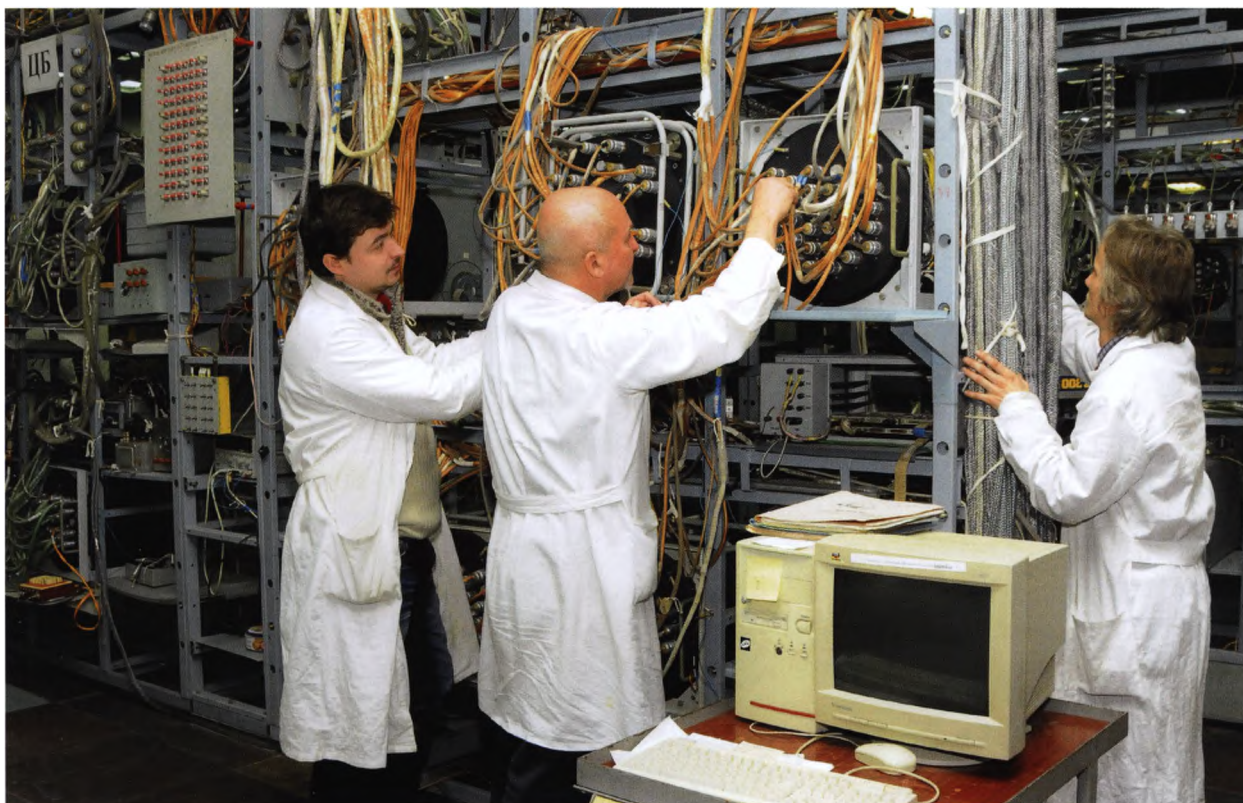
Вед. инженер С.В. Кузнецов, нач. лаб. А.Л. Рубен и вед. инженер А.В. Беликов проводят стыковку бортового вычислительного комплекса перед проведением приемо-сдаточных испытаний летного комплекта БАСУ РН «Ангара-А5».
