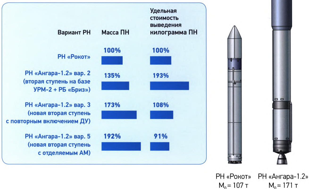
Рис. 7.1.4. Сравнение эффективности вариантов РН «Ангара-1.2» при выведении ПН на круговую орбиту высотой 1000 км и наклоном 83^\circ
