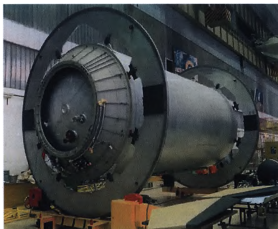
Сборка В2 (отработка динамической прочности): бак «Г» с проставкой ДУ, панели ПГС
