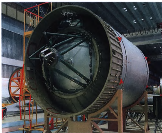
Сборка АЗ (отработка статической прочности): бак «Г», хвостовой верхний отсек, проставка ДУ
