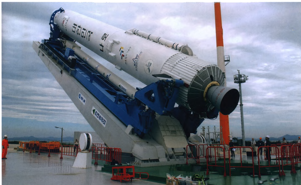
Установка KSLV-1 на стартовый стол
