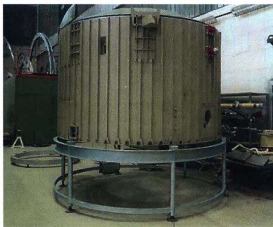
Сборка Д1 (отработка ПГС ДУ, СПП, СТ и ПБ): хвостовой отсек с теплозащит- ным экраном
