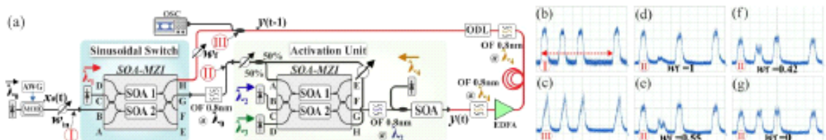
Рис. 6. (а) Экспериментальная установка, используемая для проверки механизма стробирования, включенного в полностью оптическую RNN с помощью синусоидального переключателя на основе SOA-MZI. Временные кривые (200 пс / дел), полученные (б) на входе и (в) на выходе RNN (III) для w_r = 0 . Выход переключателя (II) для (d) w_r = 1 , (e) w_r = 0,55 , (f) w_r = 0,42 и (g) w_r = 0 . Масштаб по оси Y: (3,5 мВ / дел).
