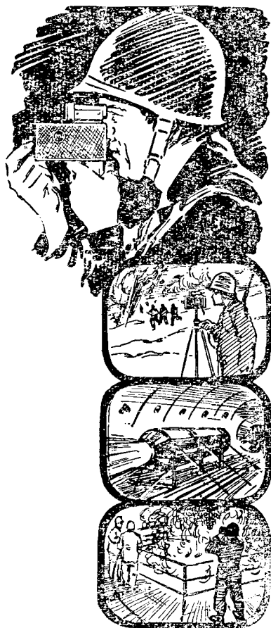
Рис. 16. Карманная ручная телевизионная камера «Телемайт». Сверху вниз: использование в полевой обстановке, при испытании реактивного мотора, при тушении пожара
