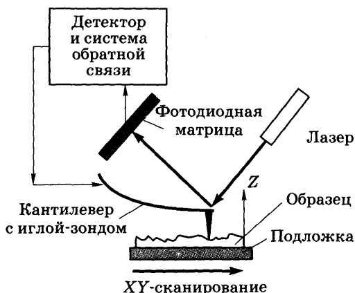
Рис. 25.7. Принципиальная схема АСМ
