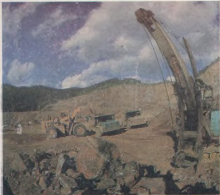
Руду из карьера выдают мощным экскаватором ЭКГ-4,6, большегрузным самосвалом БелАЗ-540
