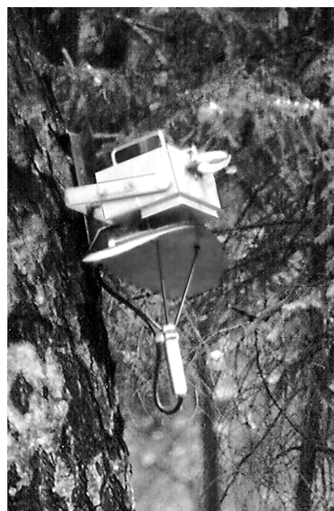
Рис.7. Установка для регистрации щелчков совок в естественных условиях.
