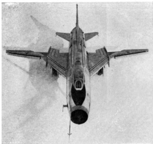
Первый в СССР са- молет с изменяемой в полете стреловид- ностью крыла.
