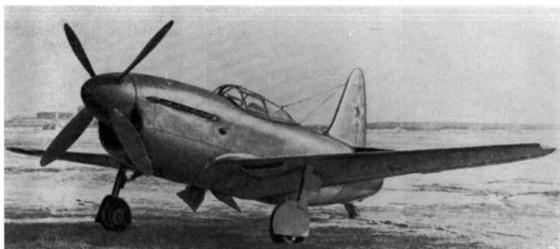
Истребитель с комбинированной силовой установкой Су-5.
