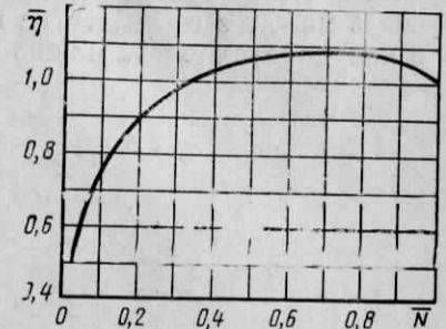
Рис. 7.13. Характеристика трехвальной ГТУ с одной ступенью сгорания
