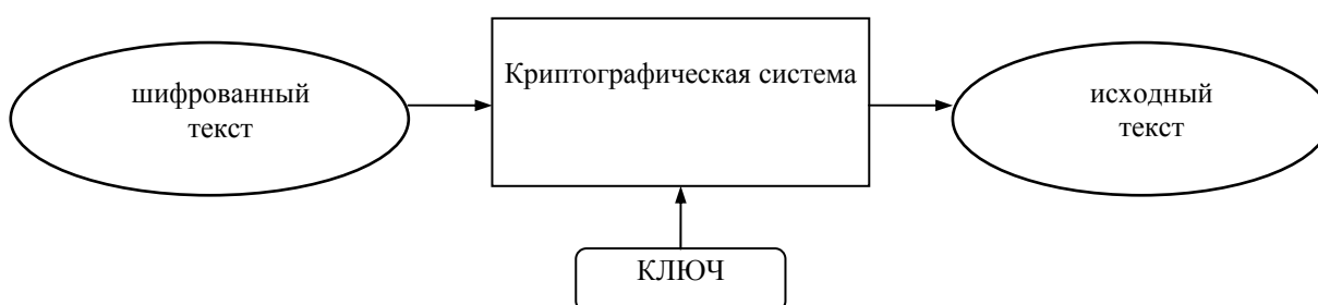
Рис.2. Процесс дешифрования данных
