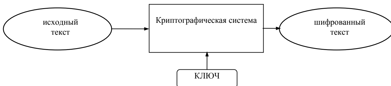
Рис.1. Процесс шифрования данных
