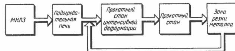
Рис.113. Схема совмещения МНЛЗ с прокатным станом
