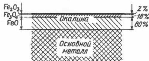
Рис. 35. Состав окалины, образовавшейся на поверхности металла при нагреве
