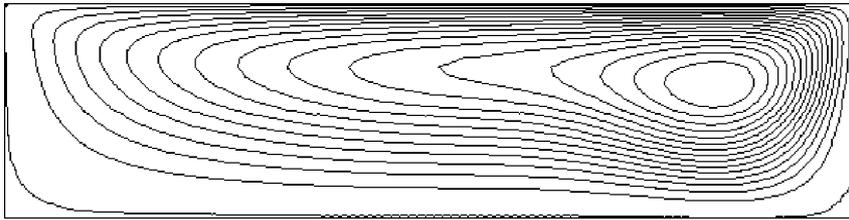
Рис. 7.15: Линии тока для  $Ma = 5$
