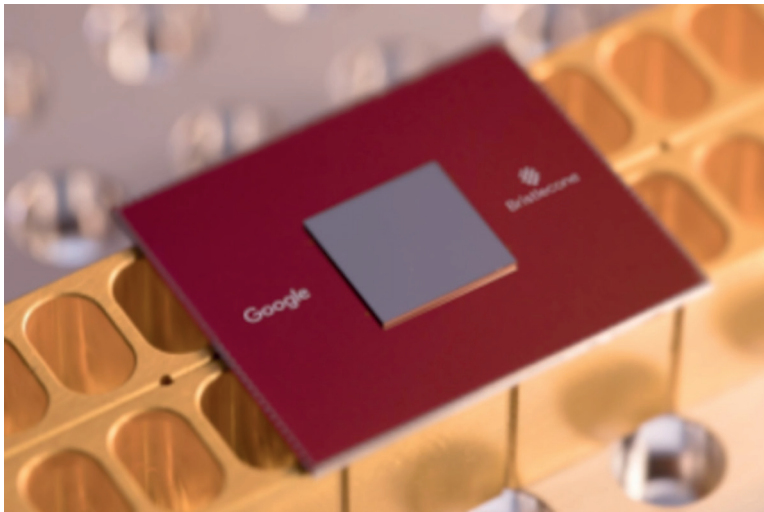
Рис. 2.5. Квантовый процессор Bristlecone компании Google, основа ее 72-битного компьютера
