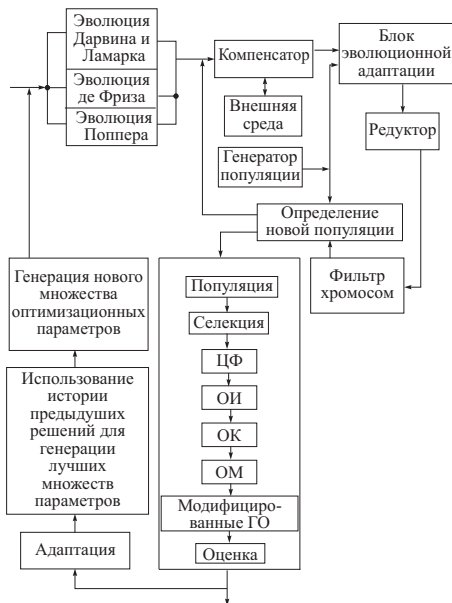
Рис. 5.39. Структурная схема генетического поиска
