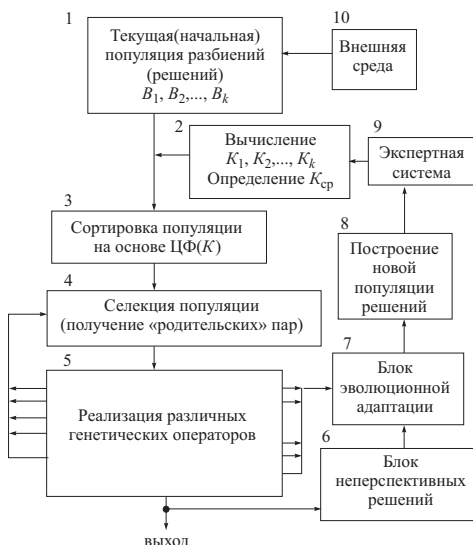
Рис. 5.1. Модифицированная схема генетического поиска для задачи разбиения
