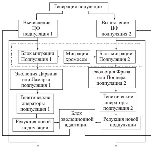
Рис. 4.20. Схема параллельного эволюционного поиска
