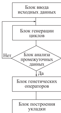
Рис. 5.26. Укрупненная структурная схема алгоритма планаризации
