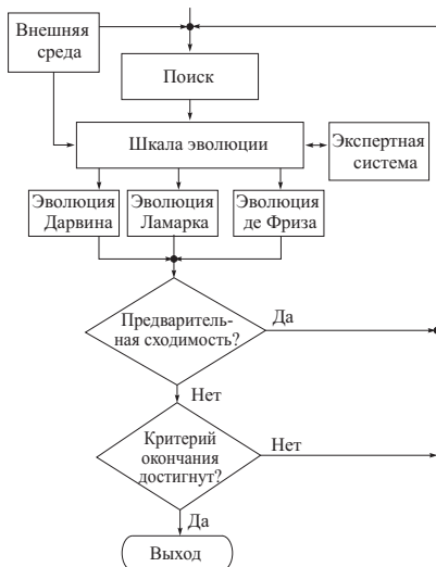
Рис. 4.18. Базовая структура генетического поиска на основе использования эволюций Дарвина, Ламарка и де Фриза
