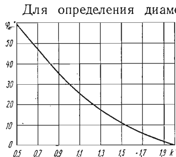
Рис. 22. Кривая изменения угла пересечения контура калибров в зависимости от отношения перемещений валков двух клетей.
