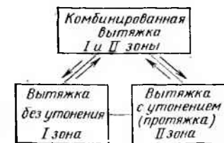
Рис. 6. Схема общей классификации процессов вытяжки
