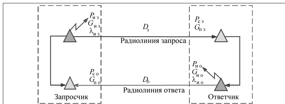
Рис. 5.5. Структура радиолинии с активным ответом
