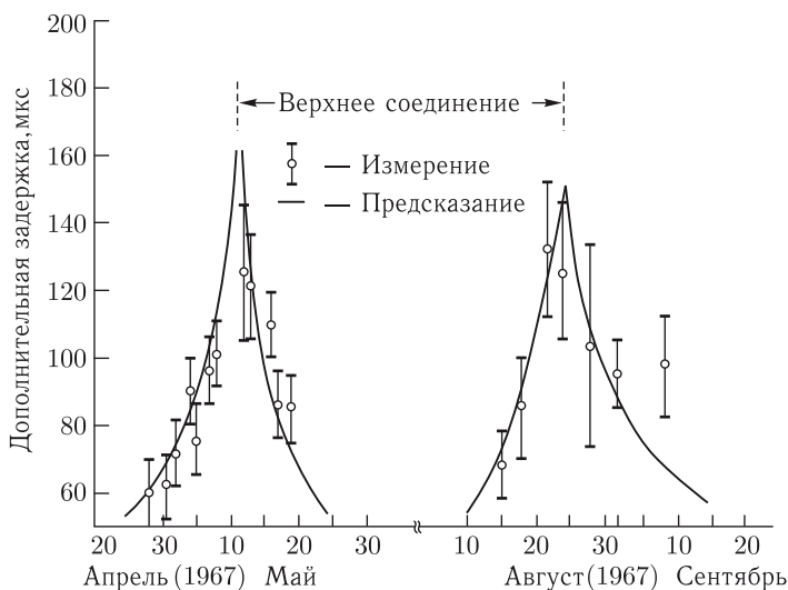
Рис. 20. Задержка Шапиро при радиолокации планет. Сигнал возвратится на Землю чуть позже, чем если бы гравитационное поле Солнца не искажало пространство-время в своей окрестности
