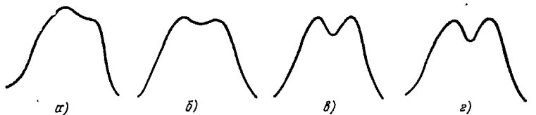
Рис. 3-9. Поле излучения в дальней зоне частотного ОКГ на стекле в зависимости от времени работы генератора.
