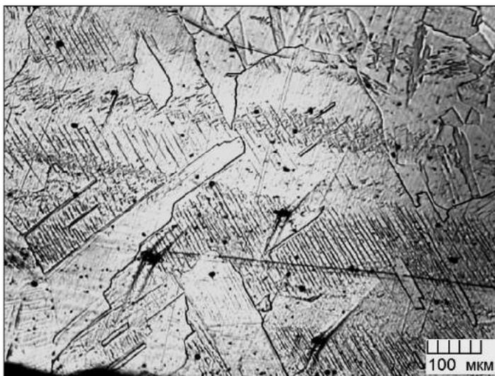
Рис. 5.6. Микроструктура аустенитной марганцевистой стали Г13 после закалки в воду с 1100 °С: аустенит с двойниками
