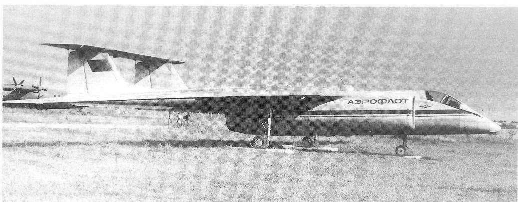
Чтобы избежать этого, разработали самолет с хвостовым оперением, установленном на тонких балках. Летчик, двигатель и стрелковая установка разместились в укороченном фюзеляже. Таким образом, коллектив нового ОКБ под руководством Мясищева при создании этой машины не пошел проторенным самолетами Локхид U-2 и Як-25РВ путем, а создал свою конструкцию, учтя опыт предшественников. Но каков будет результат этой работы, никто не знал.
