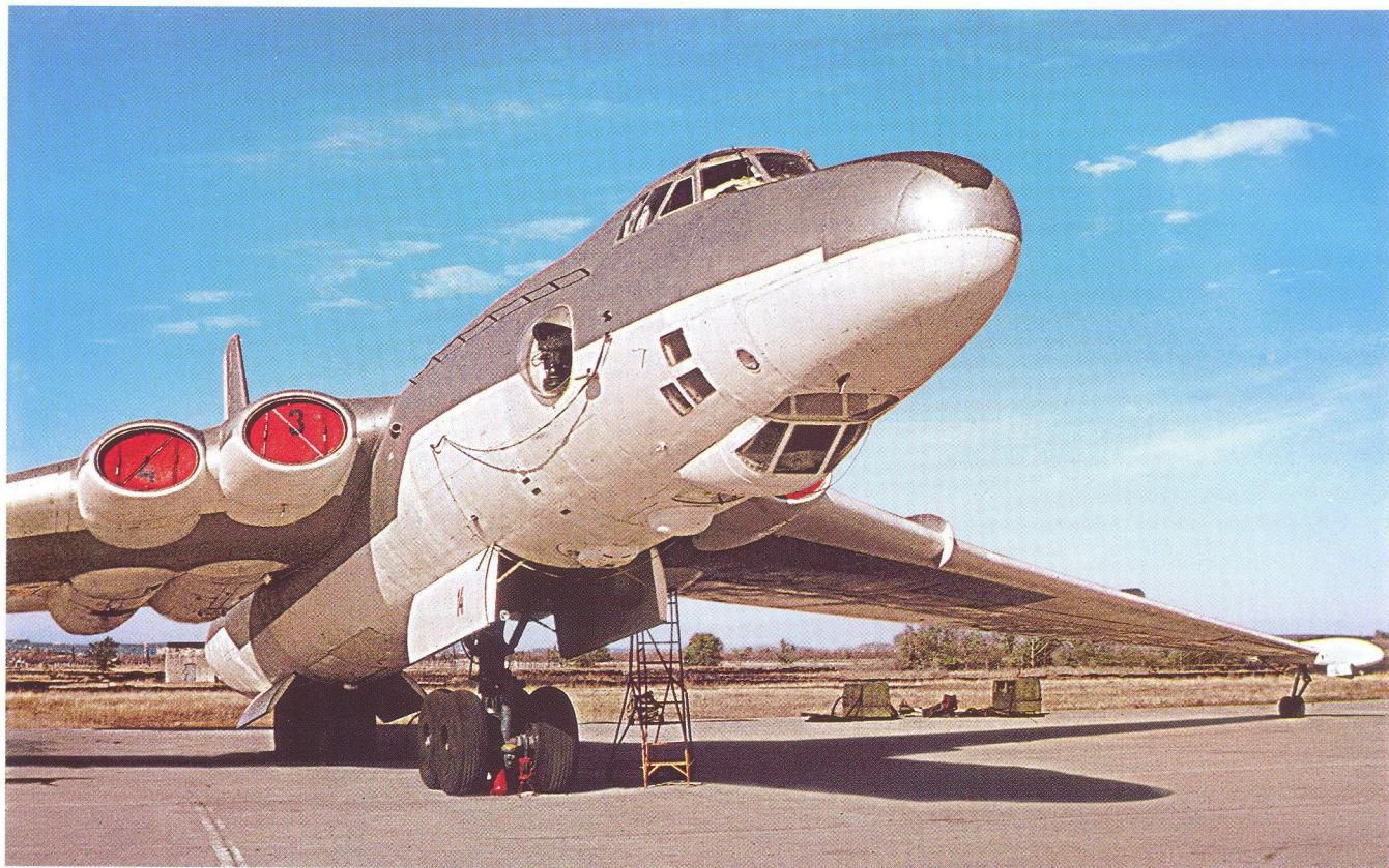
**ЗМС-2 — самолет-танкер, способный передать на борт бомбардировщиков десятки тонн горючего**
