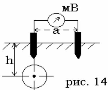
Метод заключается в определении разности потенциалов между двумя неполяризующимися электродами сравнения, один из которых установлен над исследуемой конструкцией, а другой в стороне на расстоянии «а». Если электрод, находящийся над конструкцией, является более положительным, значит в этом месте объекта существует анодная зона и
