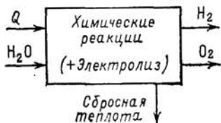
Рис. 4.5. Принципиальная схема термохимического разложения воды
