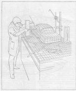
Рис. 94. Обработка изделий из древесины на станке с ленточной пилой
