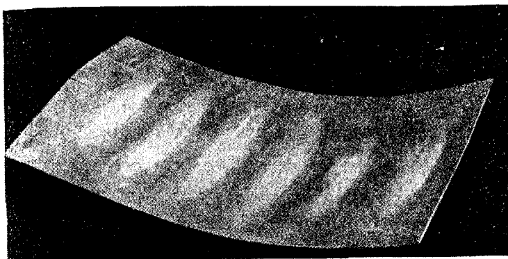
Рис. 23. Лист, прокатанный с образованием гофра
