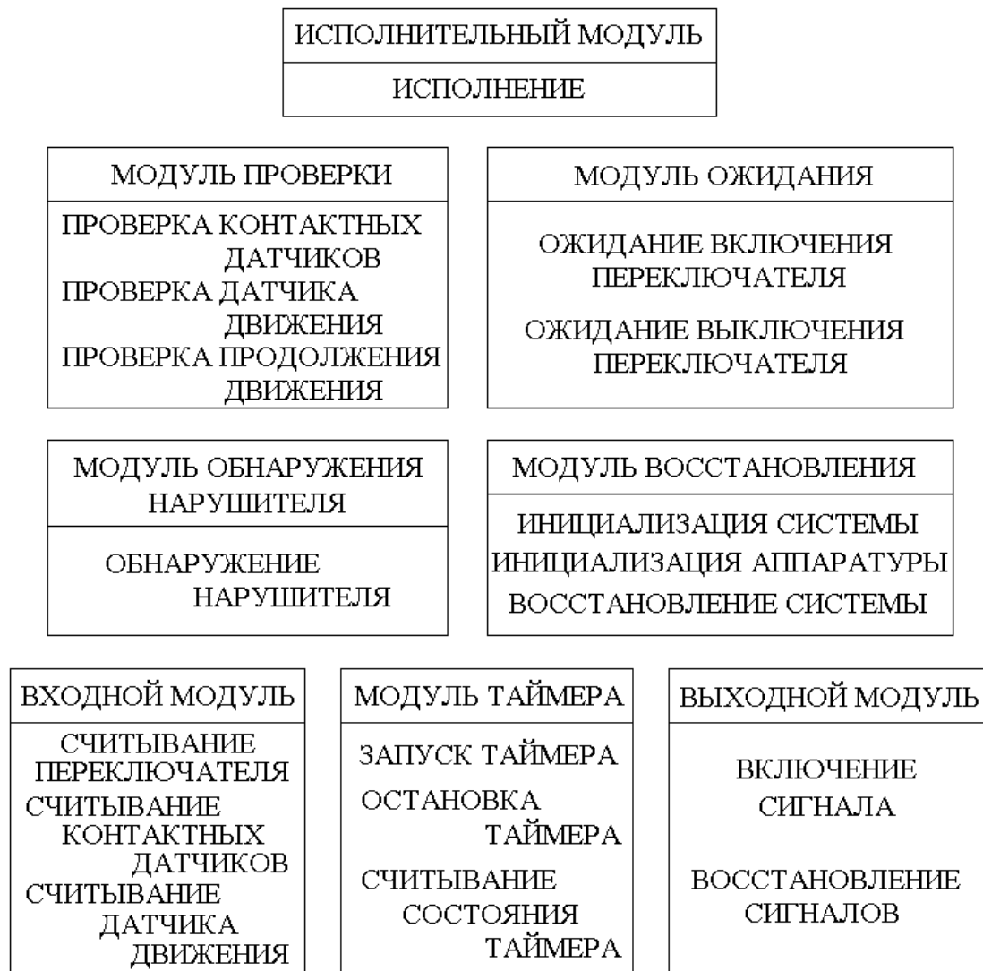
Рис. 1.6. Модульная структура системы охранной сигнализации
