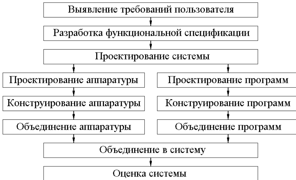
Рис. 1.2. Цикл проектирования системы
