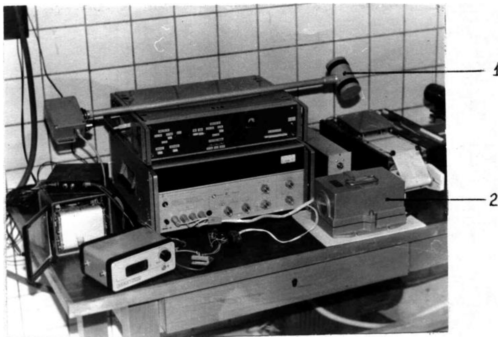
Рис. 4.1. Комплекты приборов магнитометра ММП-203 (1) и сейсмографа СМЗ-БФХ (2)
