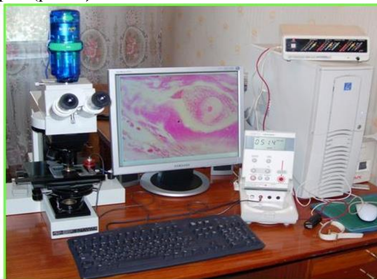
Рис.3. Фотоэлектрический метод компьютерной регистрации и анализа ритмов золь-гель переходов в живой клетке при дифференциальной интерференционной микроскопии
