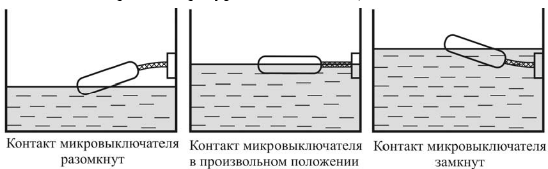
Рис.5.23. Принцип действия поплавкового сигнализатора
