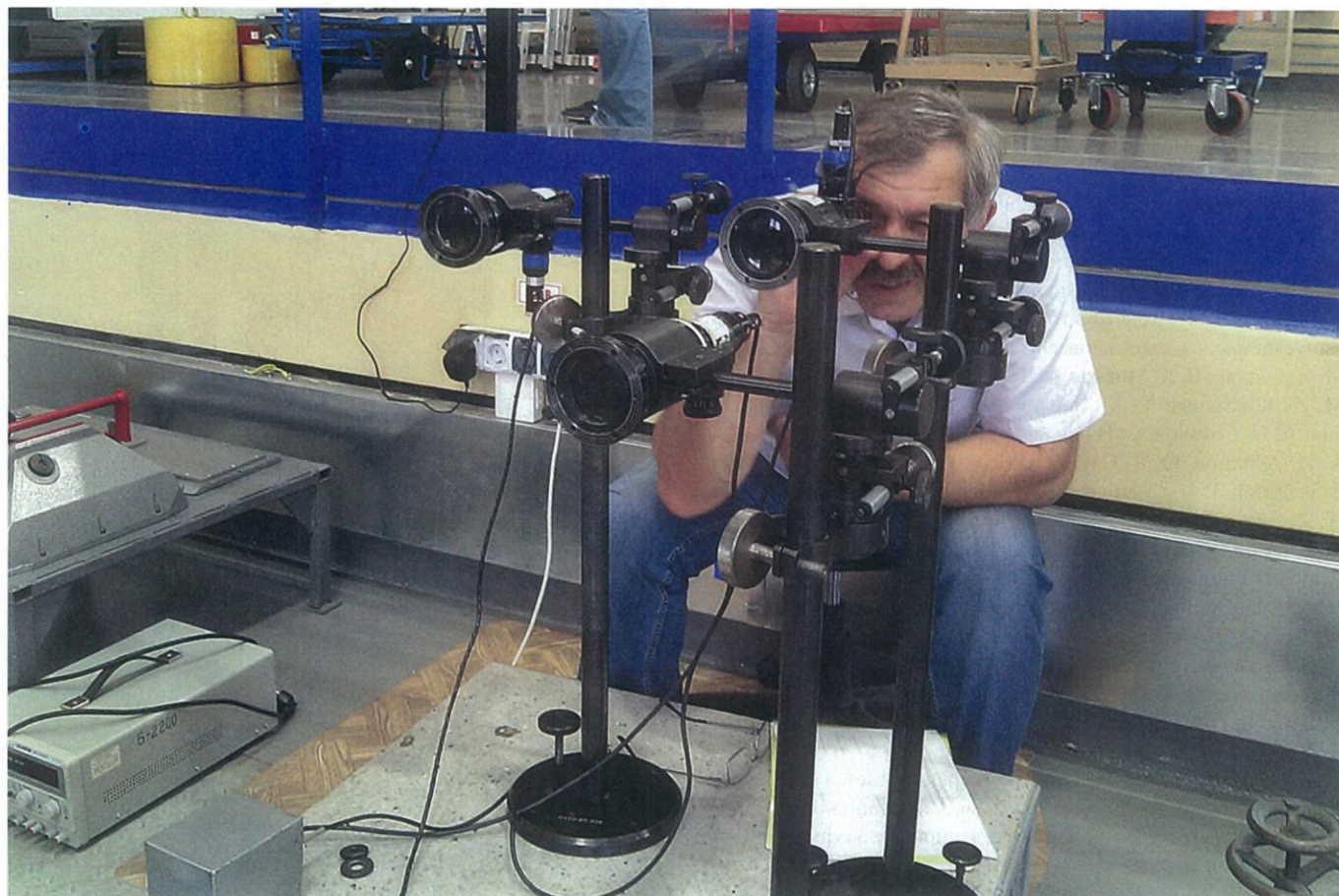
Проверка ошибки стабилизации блока зеркала (О. Б. Семёнов)
