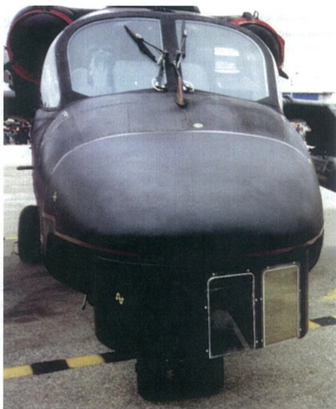
Вертолёт Ка-50 с ОПС «Шквал» и ППНВ «Сатурн»
