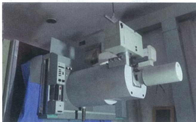
Фотокамера «Гранит-М4» установлена на рентгеновском аппарате
