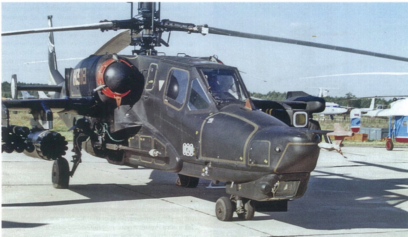
Вертолёт Ка-50 с ОПС «Шквал» и ППНВ «Сатурн»
