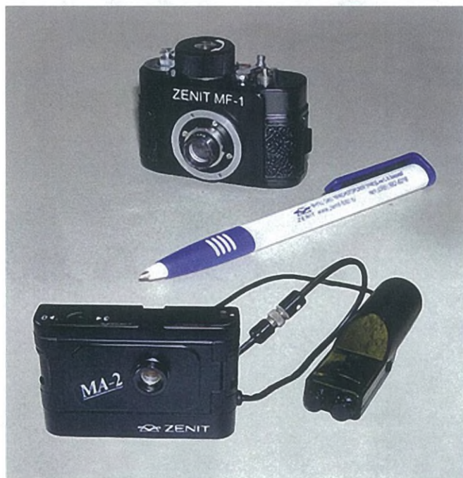
Малоформатный фотоаппарат «Зенит-MF-1»
