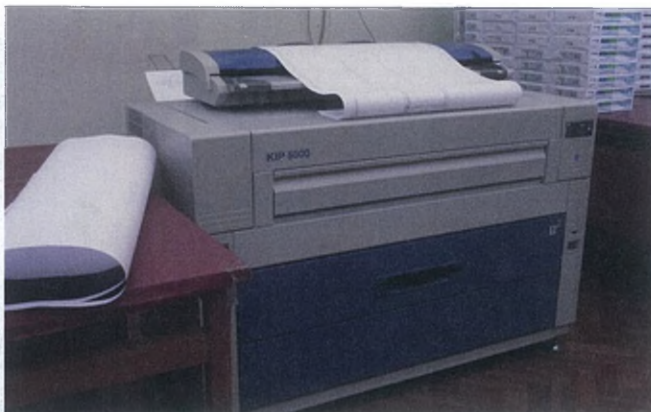
Современный плоттер KIP 5000 позволяет размножать конструкторскую документацию большого объема как на бумаге, так и на кальке для цехов основного производства
