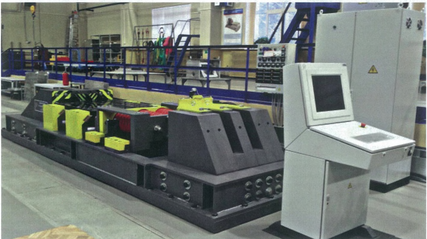
Ударная установка горизонтального направления ГУС ВСТС- 45-/300
