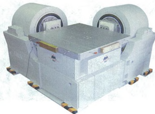
Трех-осевая система совместной вибрации G-6210-3HT-060 производства SINKEN (Япония)
