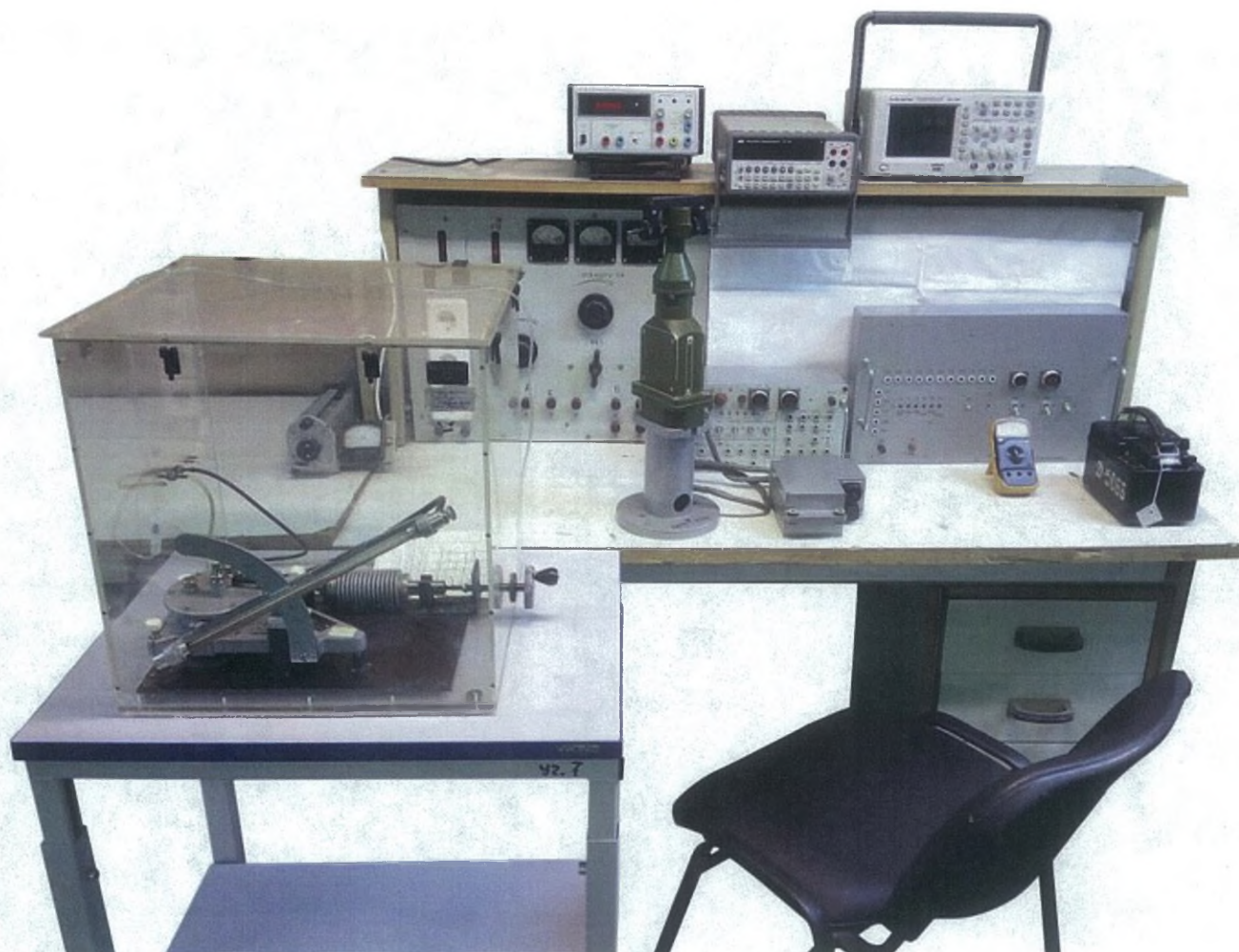
Рабочее место для ремонта датчика ветра ДВ-ЕБС
