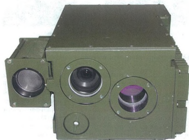
Оптико-механический блок прибора РХБ разведки
