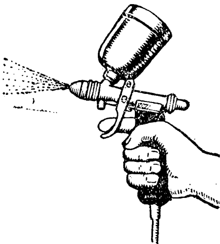
Рис. 43. Окраска пульверизацией (разбрызгиванием)
