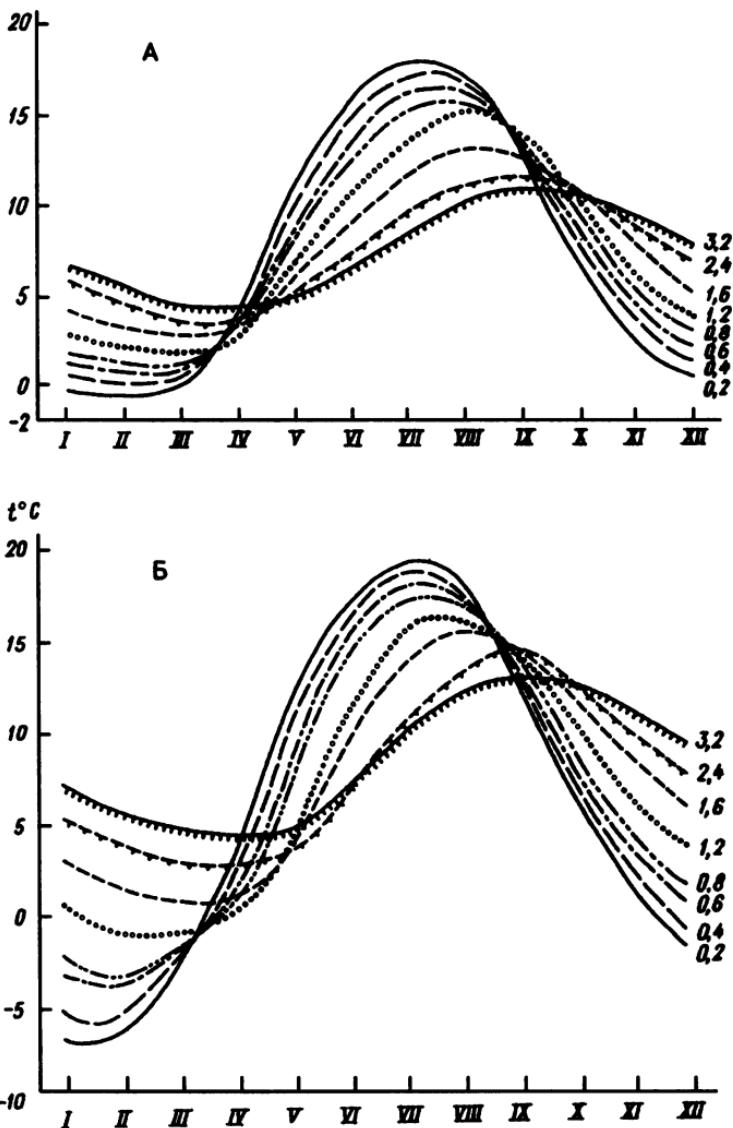
**Рис. 5.4.** Годовой ход температуры почвы на разных глубинах в Москве под травяным покровом (A) и на оголенной поверхности (Б)
