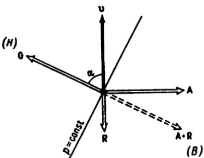
Рис. 4.18. Ветер в слое трения (равномерное прямолинейное движение воздуха при наличии силы трения):  $G$  — сила барического градиента,  $A$  — отклоняющая сила вращения Земли,  $R$  — сила трения,  $v$  — скорость ветра
