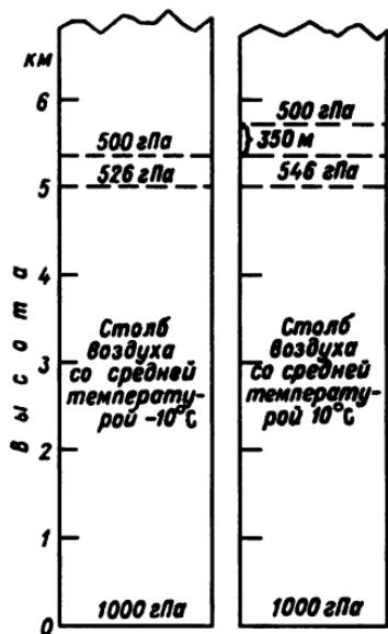
**Рис. 2.3.** Убывание атмосферного давления с высотой в зависимости от температуры воздушного столба: при одинаковом давлении внизу давление 500 гПа в теплом столбе на- блюдается на 350 м выше, чем в холодном
