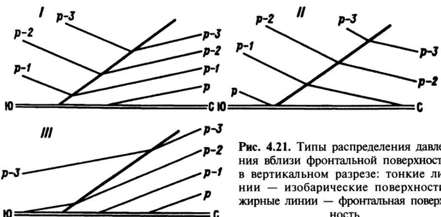
Рис. 4.21. Типы распределения давления вблизи фронтальной поверхности в вертикальном разрезе: тонкие линии — изобарические поверхности, жирные линии — фронтальная поверхность
