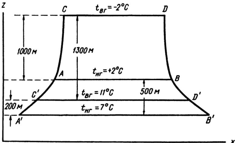
Рис. 5.19. Образование инверсии сжатия
