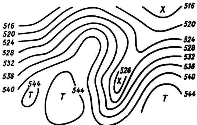
**Рис. 4.5.** Области тепла ( $T$ ) и холода ( $X$ ) на карте относительной топографии изобарической поверхности 500 гПа над поверхностью 1000 гПа: в областях тепла толщина атмосферного слоя между двумя поверхностями увеличена, в областях холода — уменьшена
