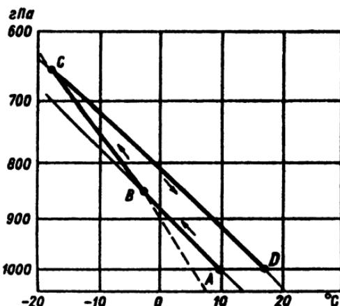
Рис. 2.4. Псевдоадиабатический процесс в координатах температура—давление: от точки *A* до точки *B* температура воздуха падает по сухоадиабатическому закону, от точки *B* до точки *C* — по влажноадиабатическому закону, от точки *C* до точки *D* — растет по сухоадиабатическому закону
