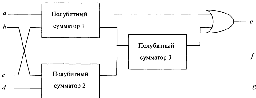
Рисунок 9.21. Функциональная схема 2-битного сумматора
