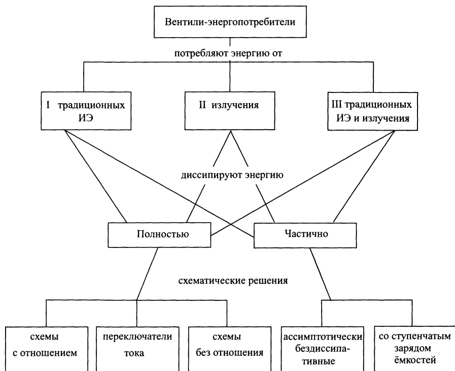
Рис. Д.2.1. Классификация цифровых вентилях.
