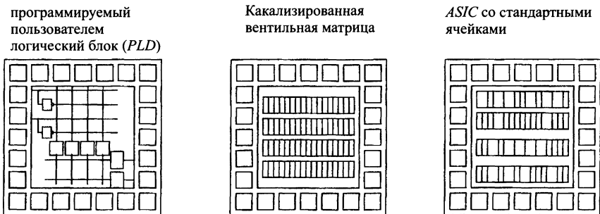
Рис. 14.1. Структура ASIC различных типов
