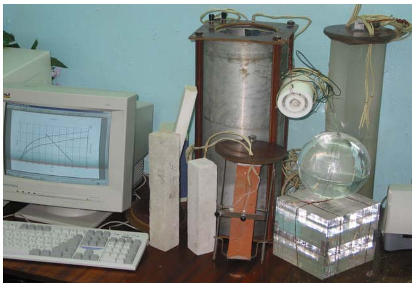
**Рис. 5.5.2. Просмотр файла на ЭВМ при определении температуропроводности красного кирпича в графическом виде программы Excel**
